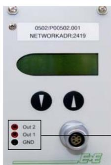
Zusätzliche Analogausgänge sind an der Frontseite eines jeden Messmoduls verfügbar.
